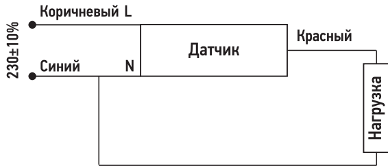
Рисунок 3. Схема подключения датчиков ДД 20ВБ
